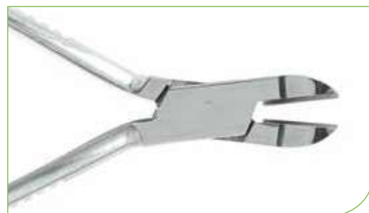
Pince coupante diagonale Réf: PIN012 Inclinaison de tête : 25° - coupe semi-rase Capacité de coupe : métaux mi-dur Ø 1.2 mm △ 120 gr - ► 145 mm - Acier nickelé
