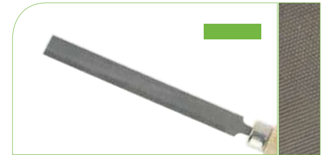
Lime à fendre Réf : LIM006 Manche en bois - taille 4 △ 25 gr - ▸ 225 X 2.5 mm
