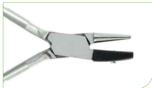
Pince à incliner Réf : PIN004 Ajustage bras de plaquettes, branches et tenons. Mors métal conique et mors nylon 7mm - Acier inoxydable △ 100 gr - ► 140 mm - Mors de rechange réf : PINPD4
