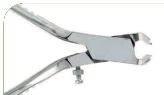
Pince coupante en bout - coupe semi-rase Réf : PIN010 Avec vis de blocage - Acier nickelé Capacité de coupe : métaux mi-durs Ø 1.2 mm △ 124 gr - ► 130 mm
