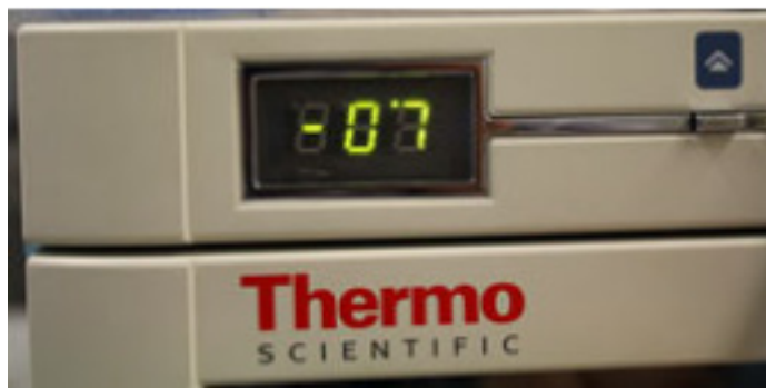
Figure 7-2: Facteur de correction de -0,7 °C affiché à l'écran
