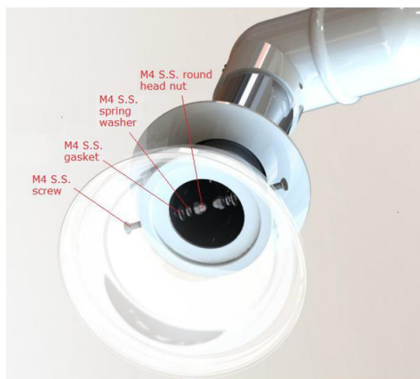
Rysunek 3. Zamocować nakręcany kołnierz leja ssącego do króćca ramienia ruchomego za pomocą śrub M4 ze stali nierdz., podkładek, podkładek sprężystych oraz nakrętek półokrągłych.
