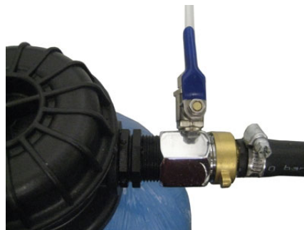
Figura 12: Grifo de evacuación abierto (para cambiar del cartucho)
