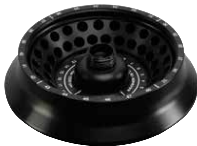
Rotor angulaire en aluminium pour microtubes 48 x 2, 45°, R max 98 mm
