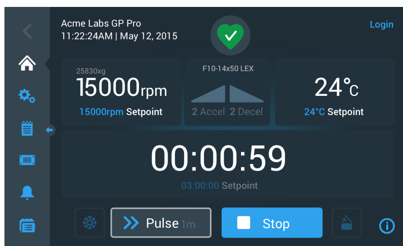
Figure 3-25: Mode impulsion : centrifugeuse fonctionnant depuis 1 minute
