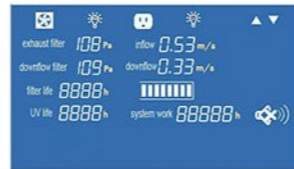
LCD display for BSC-4FA2, BSC-4FA2-GL and BSC-6FA2-GL
