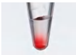
Agitation imparfaite des échantillons
