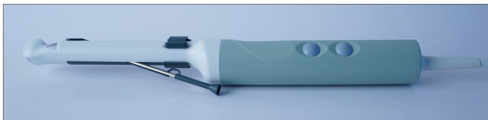
Figure 11. Guide de biopsie et guide d'aiguille montés sur l'E14C4t.
