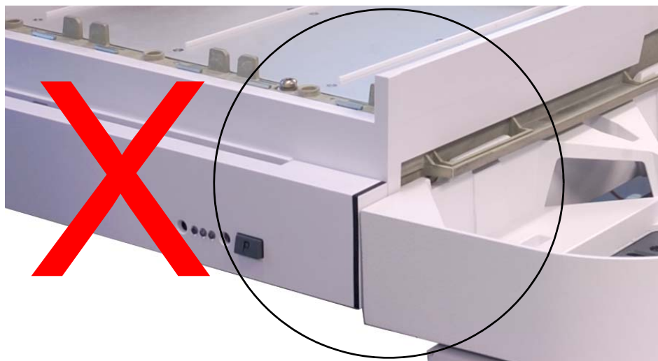
Figure 6 Porte-échantillons mal installé
