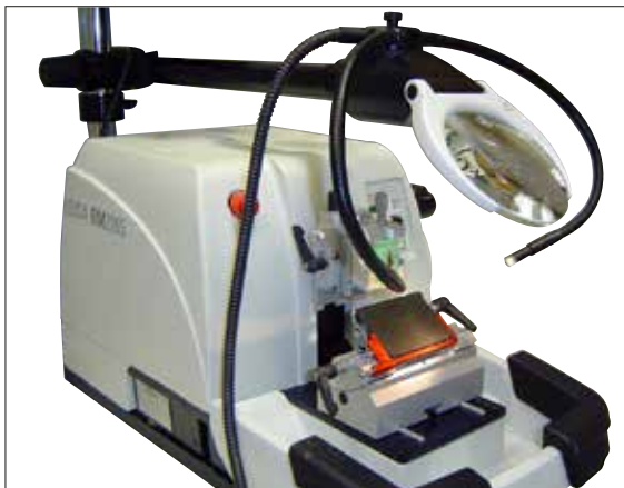
Fig. 70, microtome à rotation Leica après montage des accessoires en option : loupe et guide d'ondes optique
